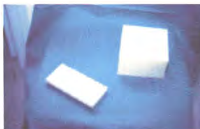
Colchón celdas geométricas (Inferior) Colchón espuma elástica y viscosa reactiva a la temperatura (Superior)
